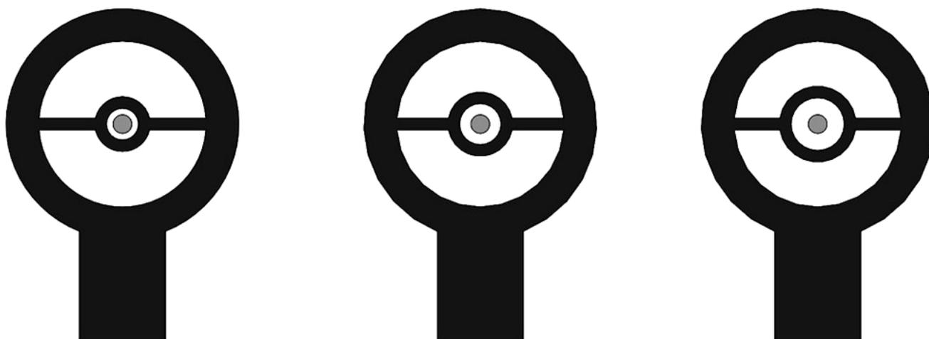
**Рис. 6. - Мушки с диаметрами 2.7 мм., 3.5мм. и 4.5 мм.**
